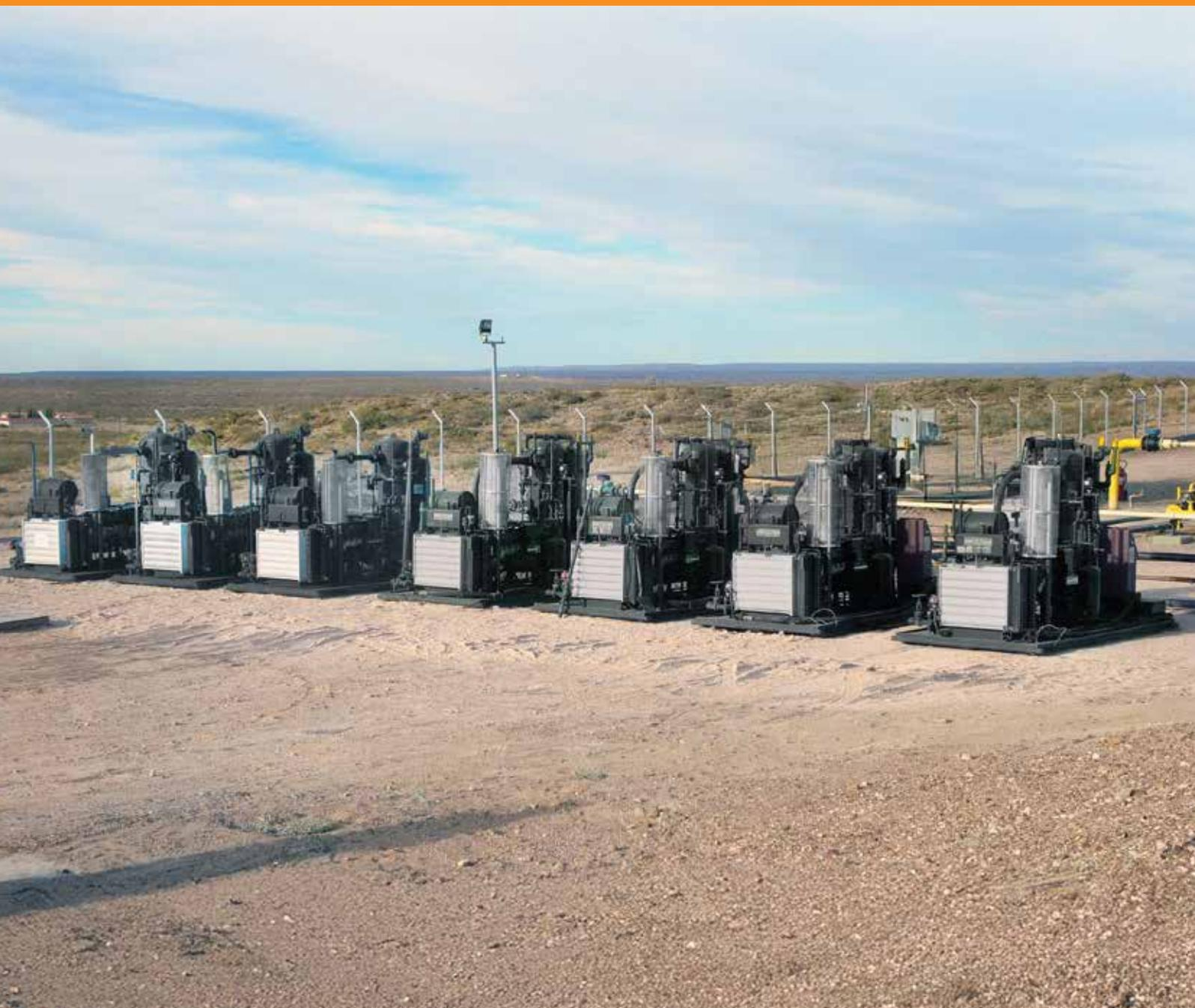
Este equipo portátil está diseñado para la compresión eficiente de gas en pozos marginales, sin necesidad de obras civiles.
